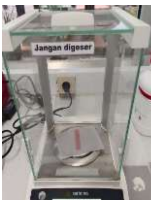
Gambar 4. Penimbangan massa kering dan massa basah plat akrilik heat cured
